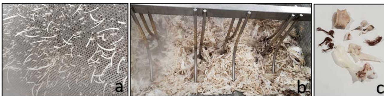
Figur 6: Reaktoren har en innertank som tar ut beina på en effektiv måte.
